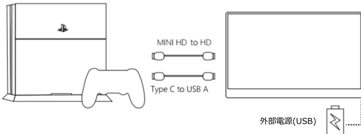
注)HDMI ケーブルを接続するときは、必ず電源ケーブルを接続してから HDMI ケーブルを接続して、信号が確実に伝送されるようにしてください。
