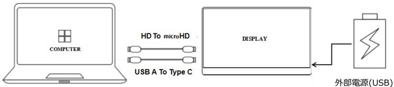
本製品は microHDMI ポートを搭載しています。本機側 microHDMI とコンピューター側 HDMI ポートを接続してください。また電源供給用に Type-C to USB ケーブルで接続します。USB ポートのないコンピューターの場合は 5V/2A 以上の外部電源に接続する必要があります。
