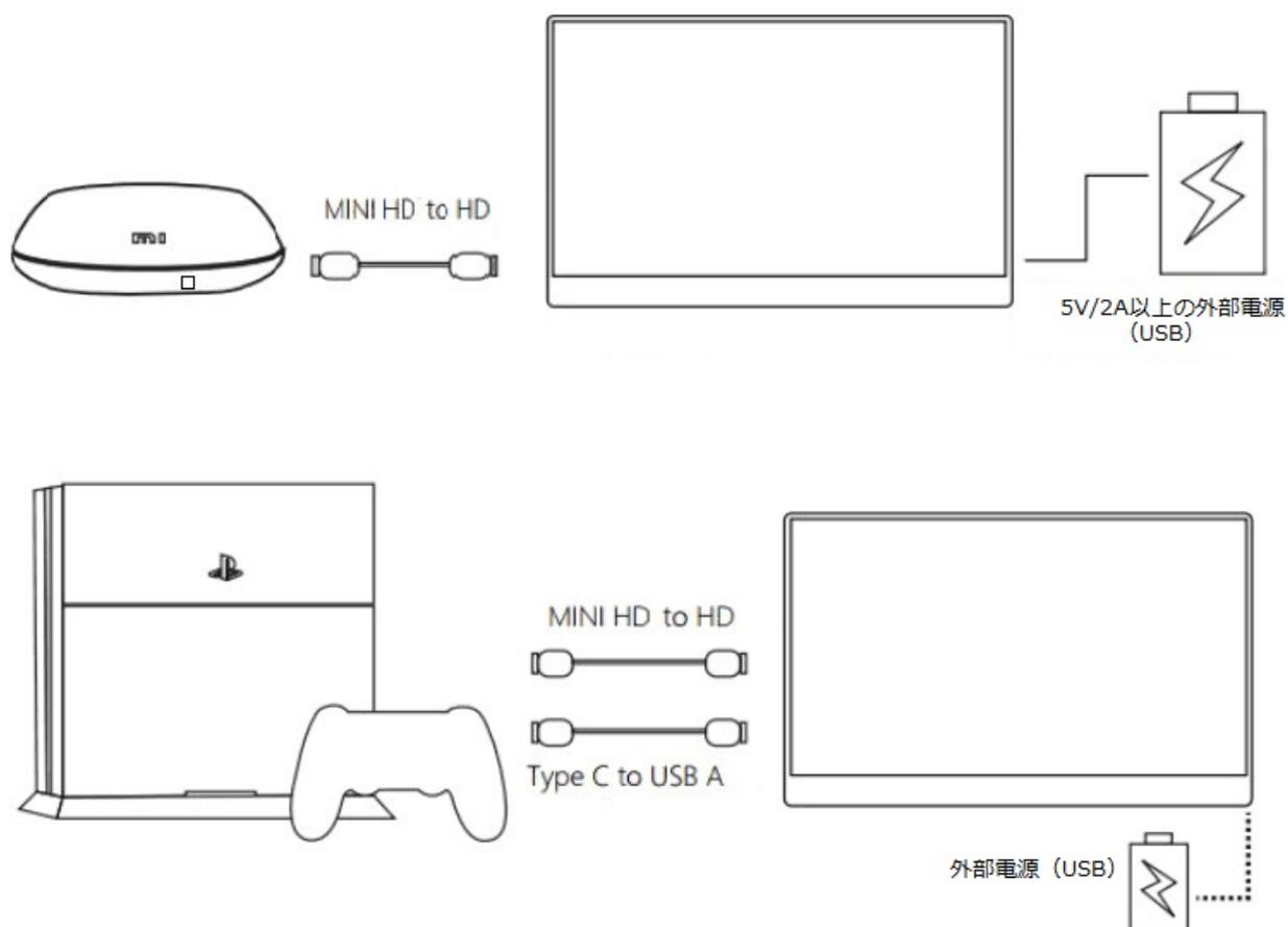
注)HDMI ケーブルを接続するときは、必ず電源ケーブルを接続してから HDMI ケーブルを接続して、信号が確実に伝送されるようにしてください。
