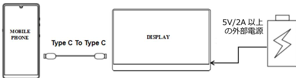
※Type-C ケーブルを使用してスマートフォンと接続できます。スマートフォン側の設定に応じてスマートフォンの画面やユーザーインターフェイスを表示することができます。
