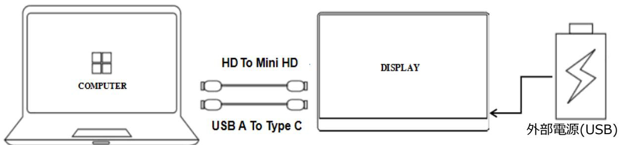
本製品は miniHDMI ポートを搭載しています。本機側 miniHDMI とコンピューター側 HDMI ポートを接続してください。また付属の電源アダプターまたは電源供給用に Type-C ケーブルで接続します。USB ポートのないコンピューターの場合は付属のアダプターまたは 5V/2A 以上の外部電源に接続する必要があります。
