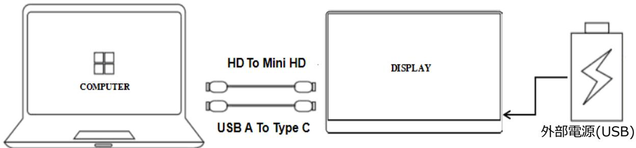
本製品は miniHDMI ポートを搭載しています。本機側 miniHDMI とコンピューター側 HDMI ポートを接続してください。また電源供給用に Type-C to USB ケーブルで接続します。
