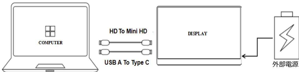
本製品は miniHDMI ポートを搭載しています。本機側 miniHDMI とコンピューター側 HDMI ポートを接続してください。また付属の電源アダプターまたは電源供給用に Type-C ケーブルで接続します。USB ポートのないコンピューターの場合は付属のアダプターまたは 5V/3A 以上の外部電源に接続する必要があります。
